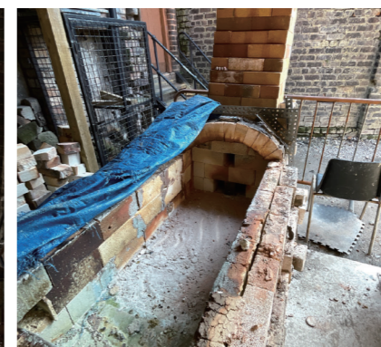
横引き式試験用ソーダ窯
